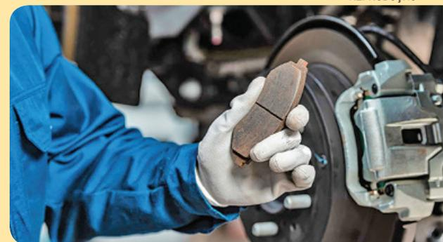
As pastilhas de freio são uma das principais responsáveis pelo bom funcionamento do processo de frenagem do seu veículo. Esse procedimento acontece por meio da fricção entre os componentes, o que gera uma pressão que, consequentemente, é aplicada no rotor de freio, diminuindo a velocidade do carro.
